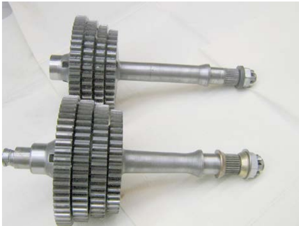
Getriebezahnräder u. Hinterachsmuttern von GS4 und PX Platte zum Unterlegen des Bremsbackens
