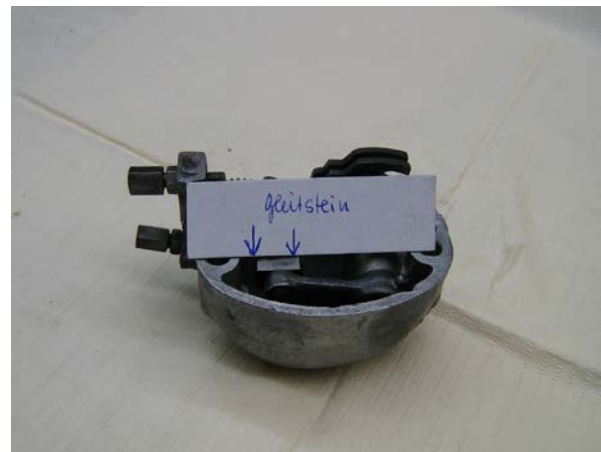
Das Gleitstück ist im 3.Gang bündig m. d. Gehäuse
