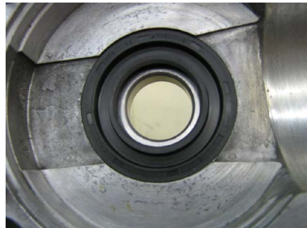
Der Federring muss immer innen liegen, (Kupplungsseite)
