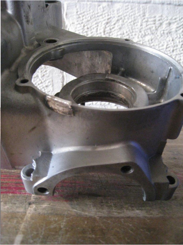
Reparatur Kupplungsseite 160 GS
