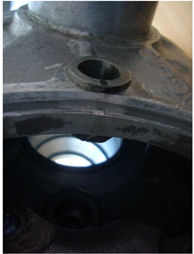
Reparatur Vorgelege 150 GS überdreht
