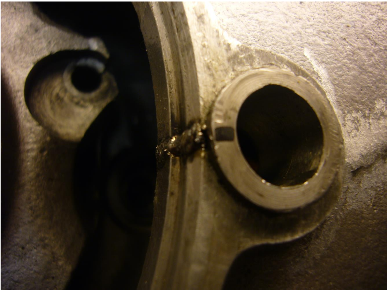
Reparatur Riss am Vorgelege 1 J.Geissler
