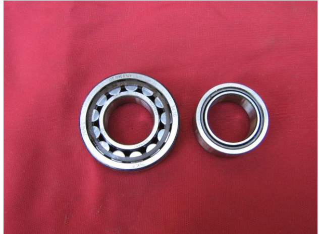
GS 160 Lager links, daneben das PX Lager -limaseitig-
