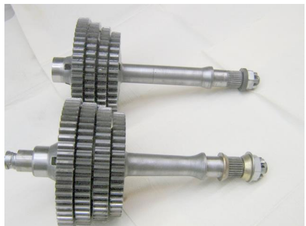
GS 160 Zahnräder unten, darüber die PX 200 Räder
