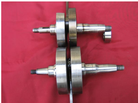
GS 160 Welle unten, darüber die 200er Welle
