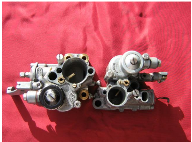
GS 160 Vergaser aufgeb. i.Vergleich zum SI 24 der PX
